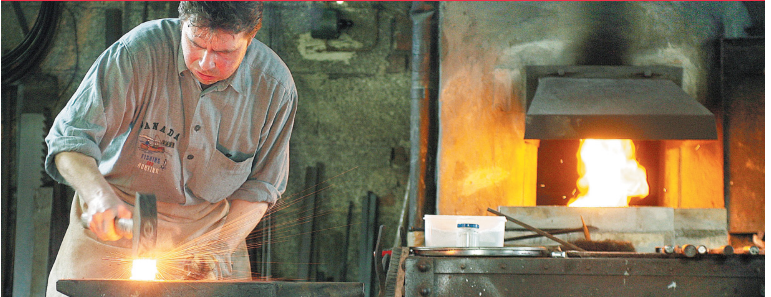
Schnelle und harte Schläge: Hans Jürgen Kugland verbindet auf diese Weise die einzelnen Stahlschichten miteinander. Ist der Metallblock erkaltet, wird er wieder im Schmiedefeuer versenkt, um ihn wieder auf exakt 1.150 Grad Celsius zu erhitzen.
