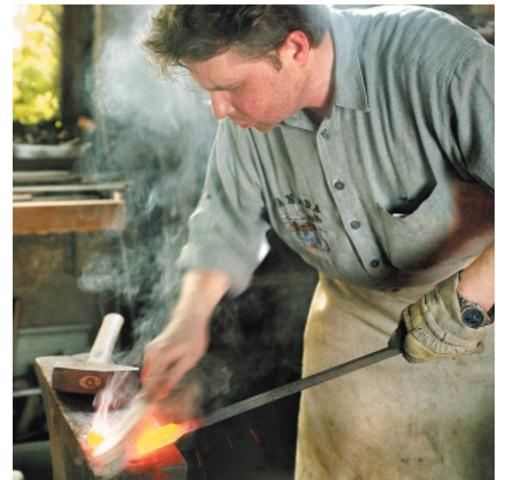
Reinigen vor dem Falten: Kohlereste werden vom glühenden Metallblock gebürstet. Dann wird der Stahl gefaltet.
