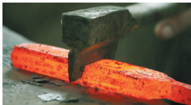
Eine Kerbe im glühenden Stahlverbund: Über diese Stelle wird der Metall-Block gleich umgeschlagen.
