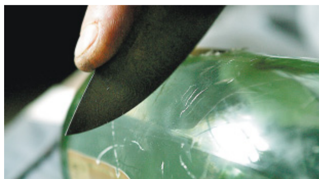
Härtetest: Eine Flasche wird angeritzt. So ermittelt Kugland, ob das Metall die nötige Beschaffenheit besitzt – und ob er gut gearbeitet hat. Klappert's nicht, war die Arbeit vergebens.
