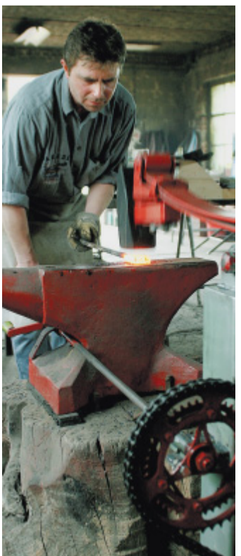
Eigenkonstruktion: Der selbstgebaute Schmiedehammer bringt das Metall in die rohe Form.
